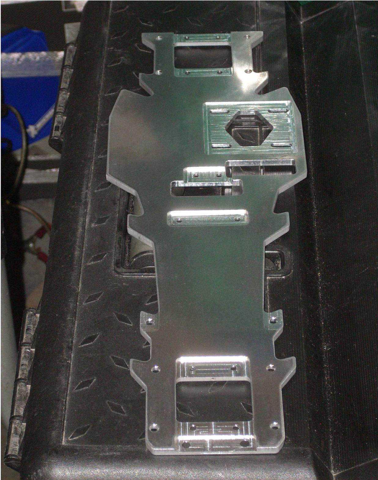
**Nuovo telaio 5mm per trazione in linea passo lungo con trazione ribassata.**
